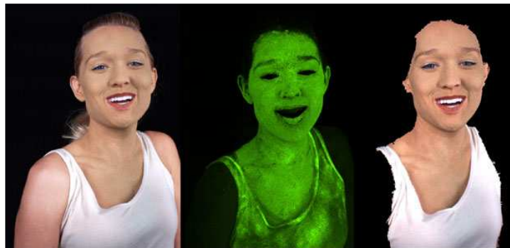
Figure 4.13. : Marqueurs passifs pour la capture des mouvements du visage, société Mova
