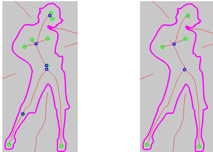
Figure 4.56. : Fusion des nœuds proches (à gauche) et suppression des petites branches (à droite)
