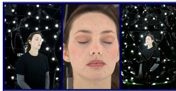
Figure 4.14. : Marqueurs passifs pour la capture des mouvements du visage, société Image Metrics
