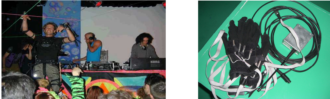
Figure 4.9. : Utilisation du Gypsy MIDI , société Sonalog (à gauche) – Data Gloves (à droite)
